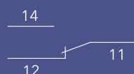
Схема электрическая принципиальная комбинированного контакта с функцией сигнала аварии (вспомогательный контакт + контакт сигнализации)
